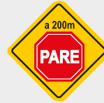
Proximidad de señal restrictiva (pare)
